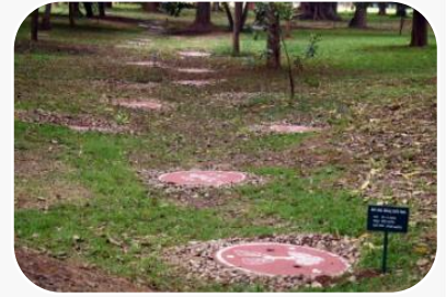
पार्को में फिल्टर के साथ उथले रिचार्ज पिट का निर्माण
