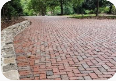
खुले स्थानों या रास्तों पर प्रवेशक (perVIOUS) फुटपाथ का उपयोग किया जा सकता है
